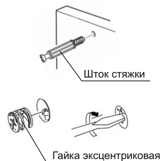
Схема 4. Установка стяжки эксцентриковой
